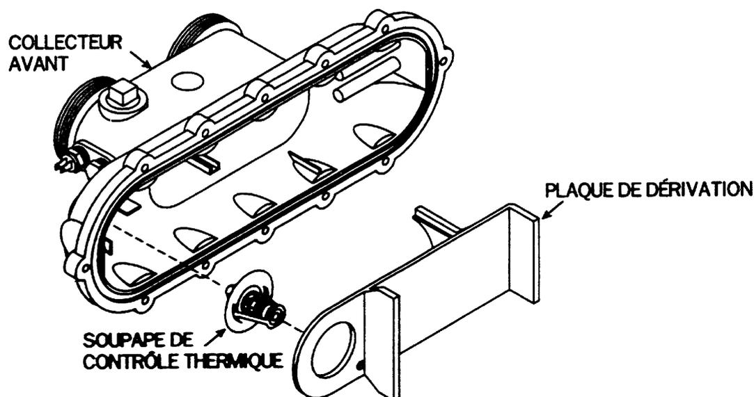
soupape adhère en position de fermeture, une quantité excessive d'eau passera à travers l'échangeur de chaleur, causant ainsi une condensation. L'un ou l'autre cas peut entraîner un chauffage insuffisant de la piscine ou du spa.
