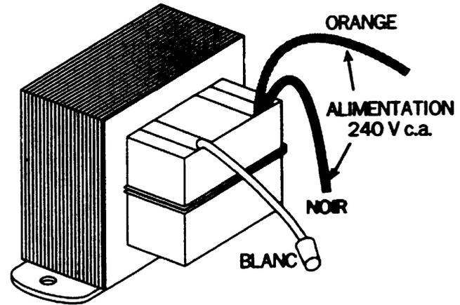
**Wiring Connection Diagram / Schéma de connexions**
