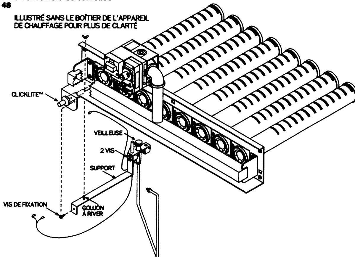
4. Pour réparer ou remplacer la veilleuse, enlever deux vis retenant la veilleuse au support de la veilleuse et débrancher la tubulure veilleuse de la veilleuse.
