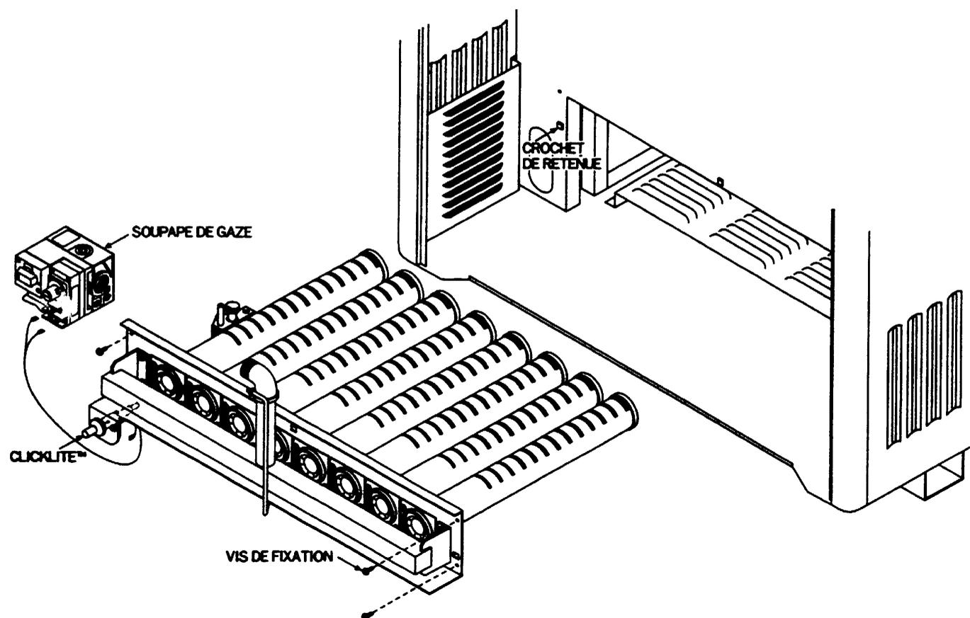
**Dépose de l'ensemble de veilleuse**
