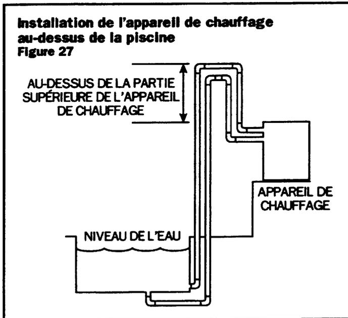
Si l'appareil de chauffage est posé à moins de trois (3) pieds au-dessus de la surface de l'eau de la piscine/du spa, poser des raccords globulaires ou des raccords à écoulement directionnel sur l'extrémité de la conduite d'eau de retour vers la piscine/le spa de manière à créer
