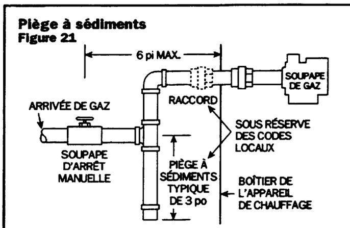
**Ne pas utiliser de raccords d'appareil flexibles sur des raccords de gaz à moins que le raccord ne soit homologué par l'A.G.A. pour installation extérieure et ne comporte une indication de la capacité en BTUH (qui doit être égale ou supérieure à l'entrée nominale de l'appareil de chauffage) et du type de gaz (naturel ou propane liquide) à utiliser.**
