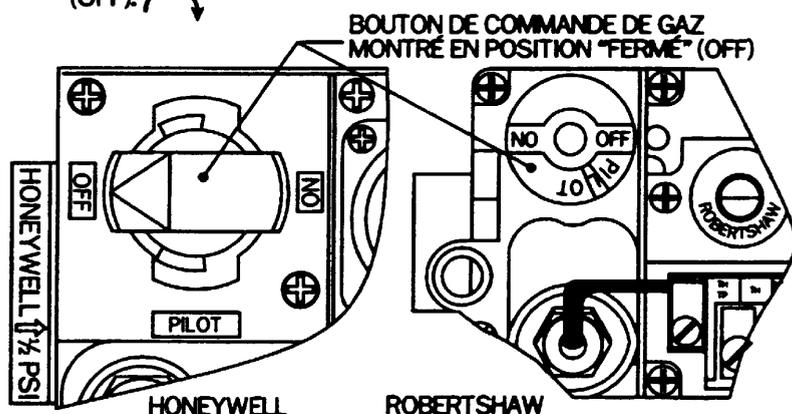
**NOTE:** Le bouton ne peut pas être tourné de "VEILLEUSE" (PILOT) à "FERMÉ" (OFF) à moins que le bouton soit légèrement enfoncé. Ne pas forcer.
