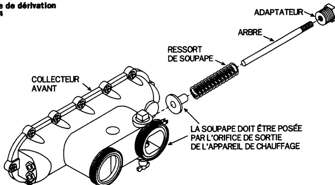
**Soupape de contrôle thermique**
