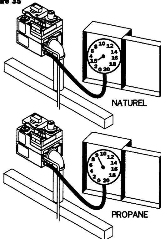
5. Ouvrir le système d'eau et mettre l'appareil de chauffage en marche en suivant les instructions d'allumage apparaissant sur l'étiquette apposée à l'intérieur du boîtier. S'il y a plus que le simple appareil de chauffage de piscine/spa raccordé à la conduite d'amenée de gaz, mettre chacun de ces appareils en marche avant de faire l'essai de l'appareil de chauffage.
