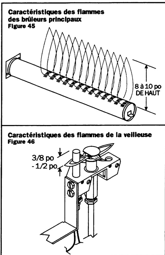
Tous les brûleurs doivent être brossés à l'aide d'une brosse métallique et doivent être exempts de charpie, de poussière et de toiles d'araignée avant chaque saison d'utilisation. Les brûleurs dont les orifices sont abîmés doivent être remplacés. Voir Figure 46 pour caractéristiques des flammes de la veilleuse (appareil de chauffage à millivolt seulement).
